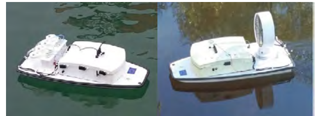
Drones aquatiques INTCATCH propulsés par une hélice (à gauche) ou un ventilateur (à droite).
