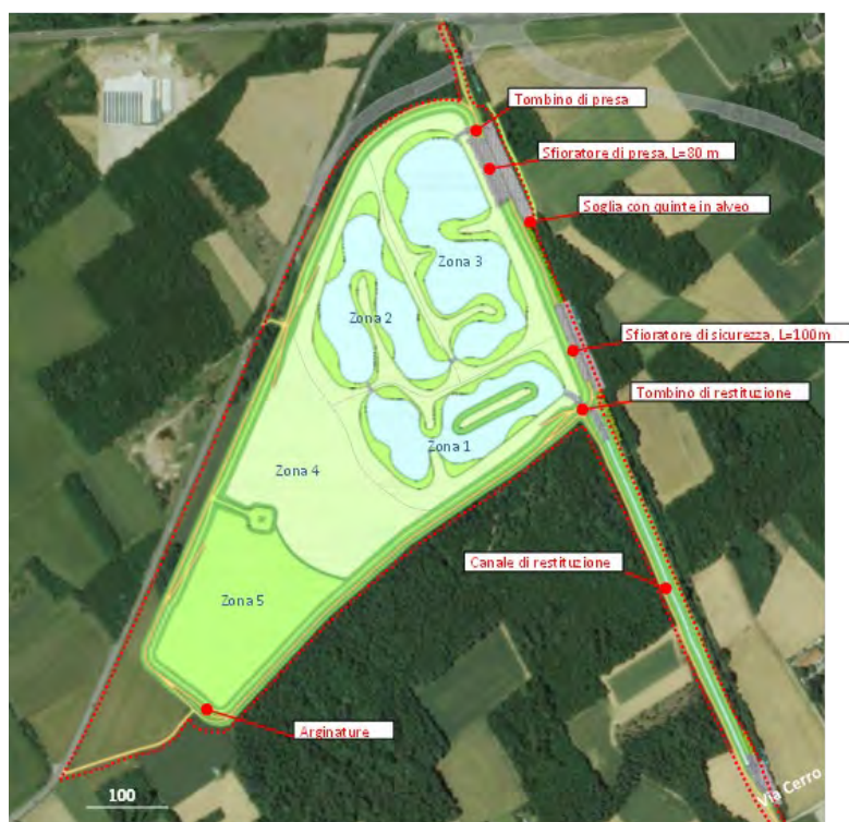
Plan des oeuvres de préventions des inondations de la rivière de Bozzente
