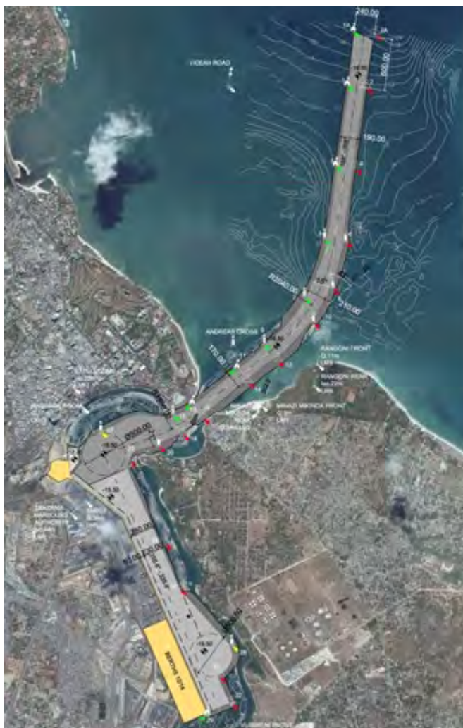
Canal d'entrée et bassin tournant de Dar es Salaam - Tanzanie
