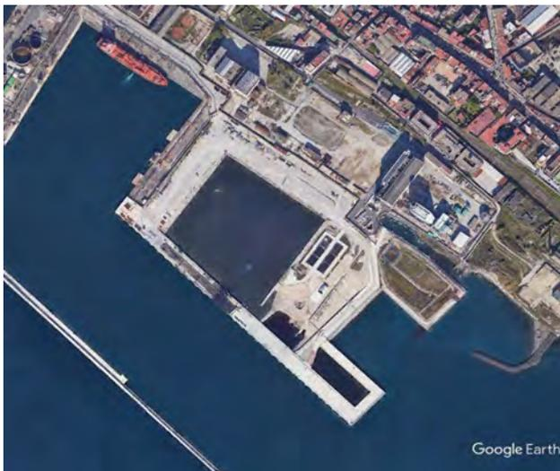
Le projet comprend le nettoyage des sédiments de fond (caractérisation et confinement des sols des points chauds vers un site de décharge), la protection de la zone par un mur de séparation afin d'empêcher les eaux souterraines polluées de pénétrer dans la FDC, la reconception des structures existantes, le dragage et les activités de remise en état des terres.
