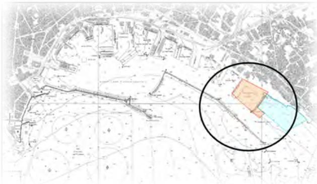
Comme on le voit sur la figure ci-dessous, le principal but de l'étude est de démontrer, à l'aide d'un simulateur temporel accéléré, qu'il suffit d'une largeur minimale de 231 m pour garantir une navigation sûre dans le canal entre le brise-lames détaché et le nouveau quai. On a atteint le but par une étude de la navigation à l'aide d'un simulateur temporel accéléré (SHIPMA).
