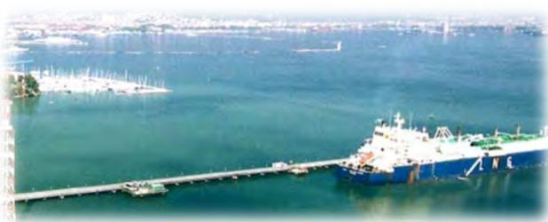
une capacité de cargaison de 145.000 m<sup>3</sup>. On a atteint le but avec une étude de la navigation à l'aide d'un simulateur temporel accéléré (SHIPMA).
