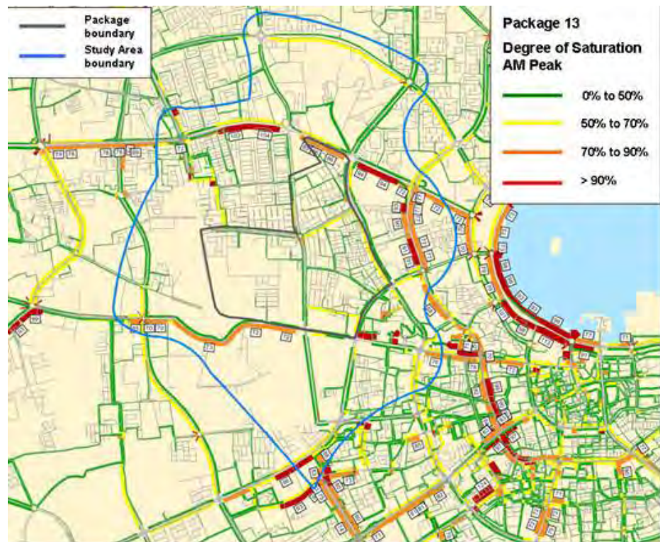
Model de trafic pour une étude de transport de 8 paquets, degré de saturation du réseau- Qatar
